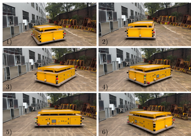
图 8 在室外平整水泥地面上的实机速度指令跟踪实验
