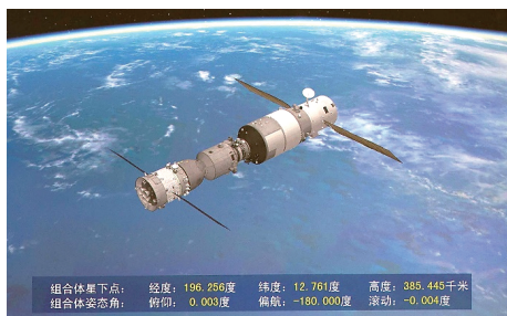
图9 “天宫二号”空间实验室与“神舟十一号”载人飞船交会对接模拟图
