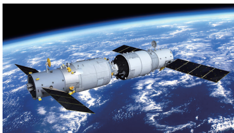
图10 “天舟一号”无人货运飞船与“天宫二号”空间实验室交会对接示意图
