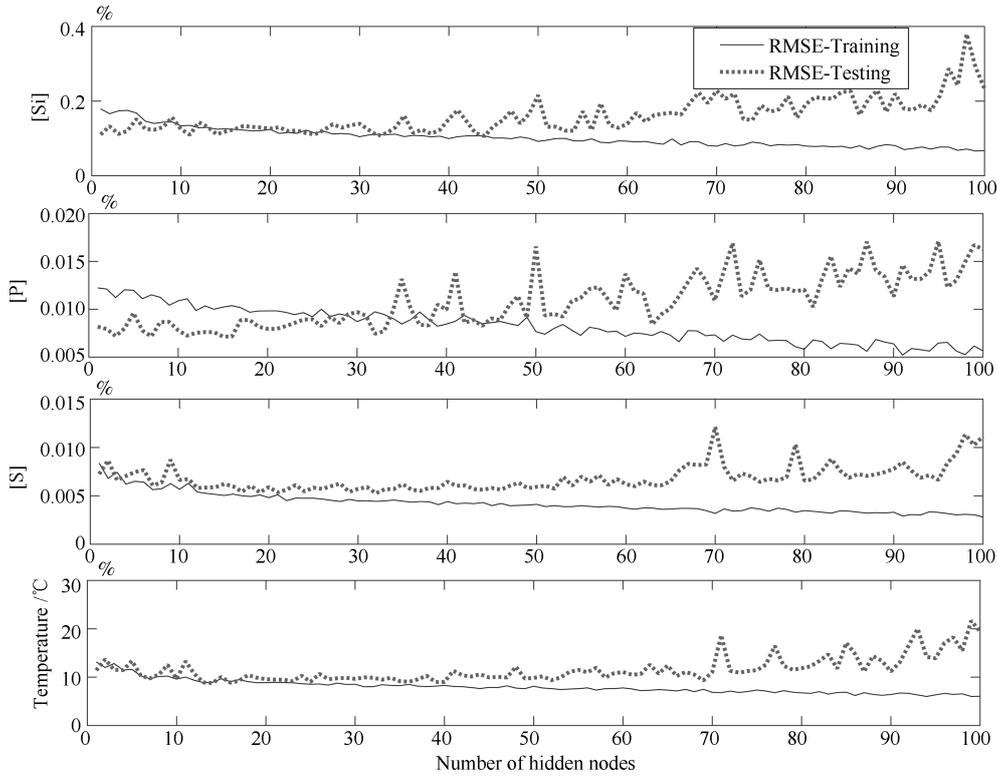
图 9 逐一增加隐层节点数时 AE-RVFLNs 训练集和测试集 RMSE 变化曲线
