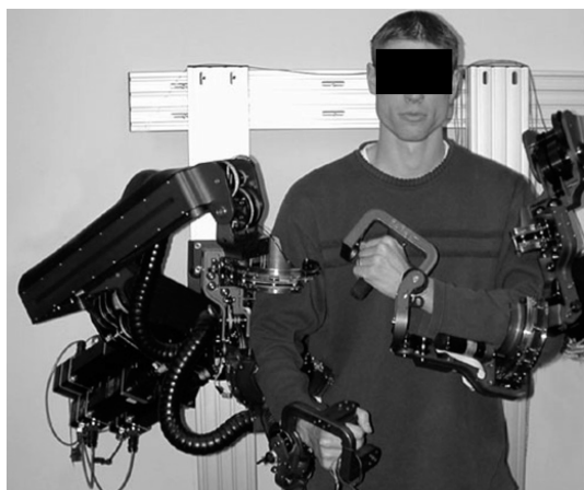
图 10 7-DOF 上肢外骨骼康复机器人 EXO-UL3
