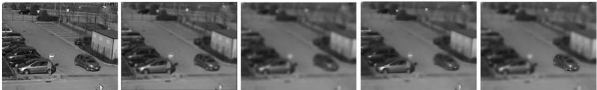
图6 ViSOR-Video00 中第 2050 帧不同滤波方案结果 (图片依次为灰度图像和高斯滤波、DOG 滤波、传统空域双边滤波、本文时空滤波结果)
