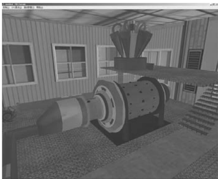
图 9 磨矿过程仿真软件 Fig. 9 Simulation software for grinding process
