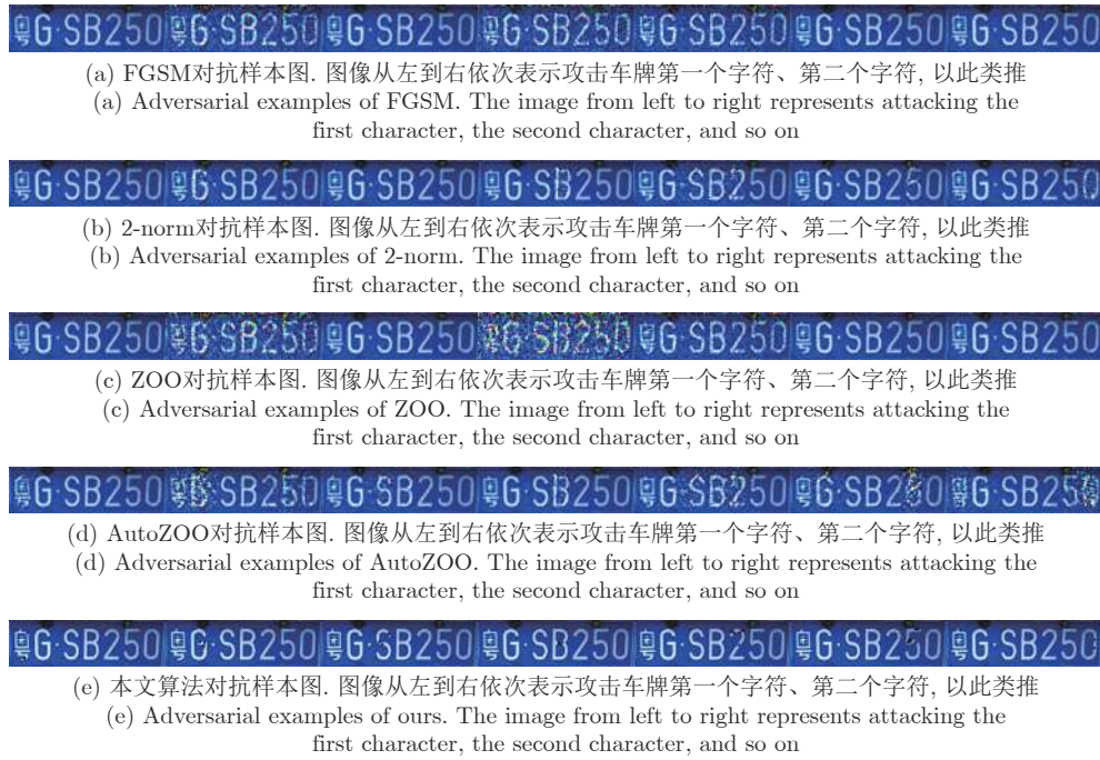
图 8 不同攻击算法攻击同一张车牌样本的不同位置的对抗样本图
