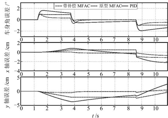
图11 奥迪 A6L 泊车误差对比 ( $v = 2.88 \text{ km/h}$ )
