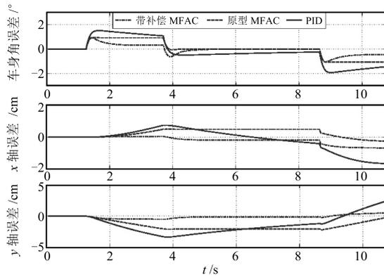
图9 一汽-大众泊车误差对比 ( $v = 2.88 \text{ km/h}$ )
